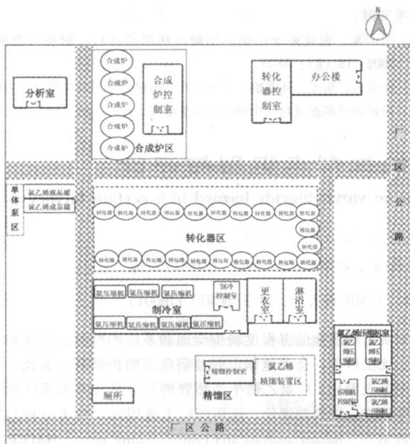
图 1 某氯乙烯生产装置平面布局示意图
