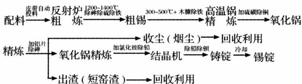
图 1 锡冶炼工艺流程
